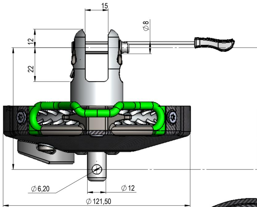
Poulie crantée / Endless line drum
